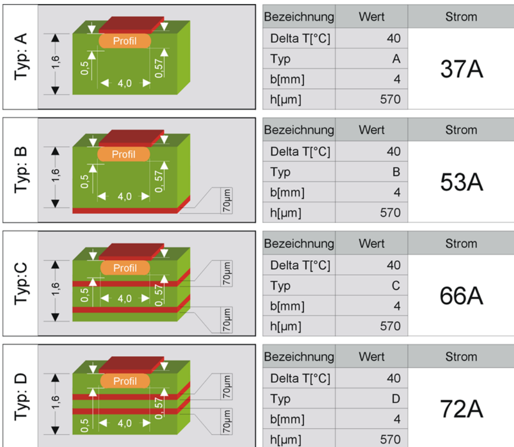
Abb. 3: Berechnung der Stromtragfähigkeit unterschiedlicher umgebender Geometrien am realen Beispiel
