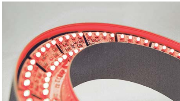
Abb. 8: Detailansicht der LED-Ringbeleuchtung: Gut zu sehen sind die individuell verstellbaren Platinensegmente des äußeren Ringes
